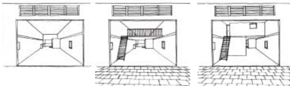
ILLUSTRATION 2 : PROPOSITION, PLAN À GAUCHE, COUPE TRANSVERSALE À DROITE, D'EXTENSIONS SUCCESSIVES APPROPRIÉES POUR UN LOGEMENT INDIVIDUEL AU VIÊT-NAM SUR LA BASE D'UNE PETITE SURFACE DE PARCELLE : 9.6x3.0m2=28.8m2, 1-4 PIÈCES 30 – CONCEPTEUR METZGER
